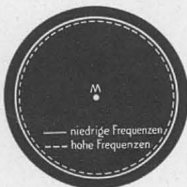
idealisierte Richtcharakteristik eines Kugelmikrofons
