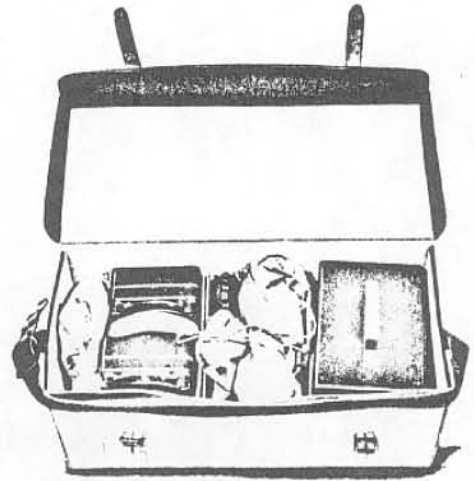
Prüf-Ledertasche mit Werkzeugen, Prüfinstrumenten und Frequenzkontrollgerät
