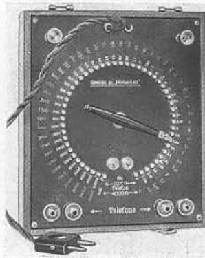
**G**rand instrument dans une boîte fermée pour des intensités jusqu'à 25000 ohms à comparer avec des téléphones de 2000 et 4000 ohms.
