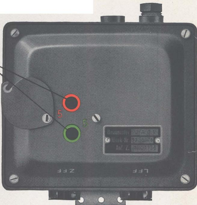
Abb. 3. AAG. 1 (Antennen-Anpassungs-Gerät)
