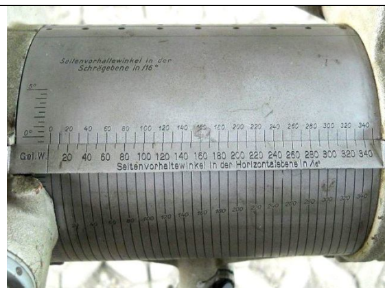
Ablesung an der Umfangstrommel des AM17: Links kann der Höhenwinkel zum Flugzeug abgelesen werden, ändert laufend. Linienschar: Umrechnung mal oder durch den cosinus des Höhenwinkels. Zahlen in 1/16 Grad. Ganz links das Handrad zur Einstellung des Höhenwinkels. Text dazu unten.
