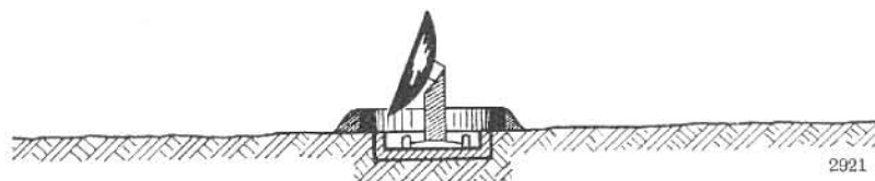
Abb. 4. Aufstellung der Anlage FuSE 62 in der Ebene.
