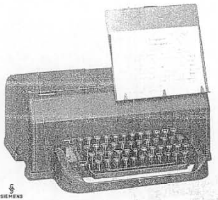
Abb. 8. Siemens-Hell-Handgeber mit Nockenabastung
