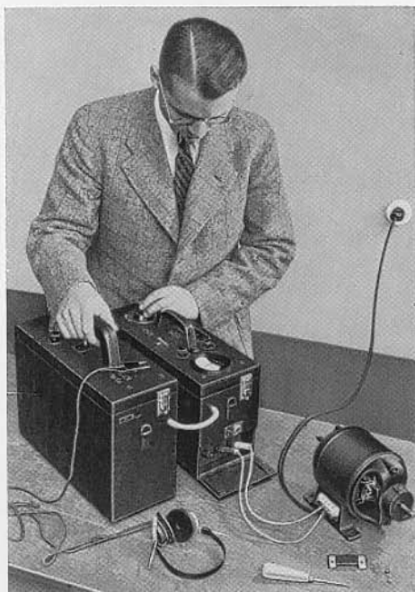
Bild 4. Messung der symmetrischen Störspannung an einem Gleich- strommotor.
