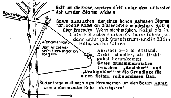
Bild 3. Umwickeln des Kabels um einen Stamm.
