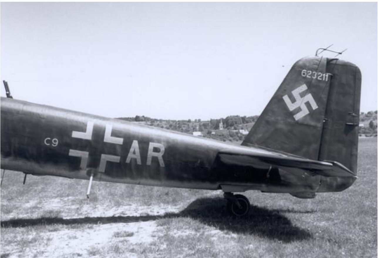
Heckteil der JU 88 G-6 mit der Antenne des Rückenwarngerätes
