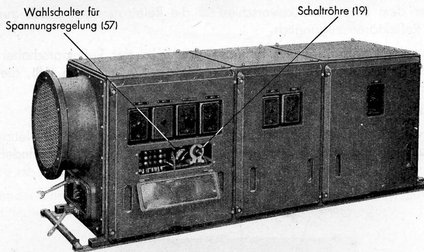
**Abb. 7: Netzanschlußgerät**
