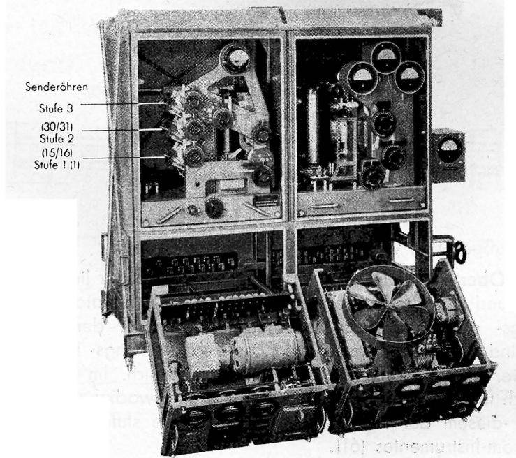
Abb. 5: Sender geöffnet
